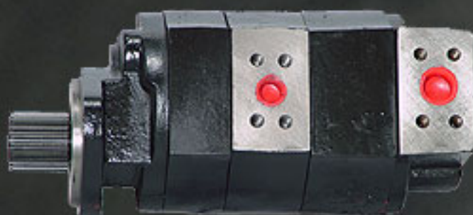
KOMATSU WA-97R EJE REFORZADO Y MANGUITO ESTRIADO DE ARRASTRE.
